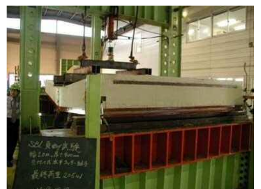
図-7 負曲げ载荷状況
